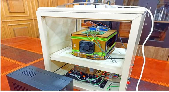
تصميم وبناء مغير جهد لأنظمة الطاقة الشمسية يستخدم فى أنظمة رى الاراضى الصحراوية البعيدة عن مصادر الكهرباء يقوم بتحويل جهد بطارية شحن منظومة الطاقة الشمسية الى جهد متغير يناسب جميع الاحمال ( اضاءة - مضخات رفع المياه وخلافه ) .
